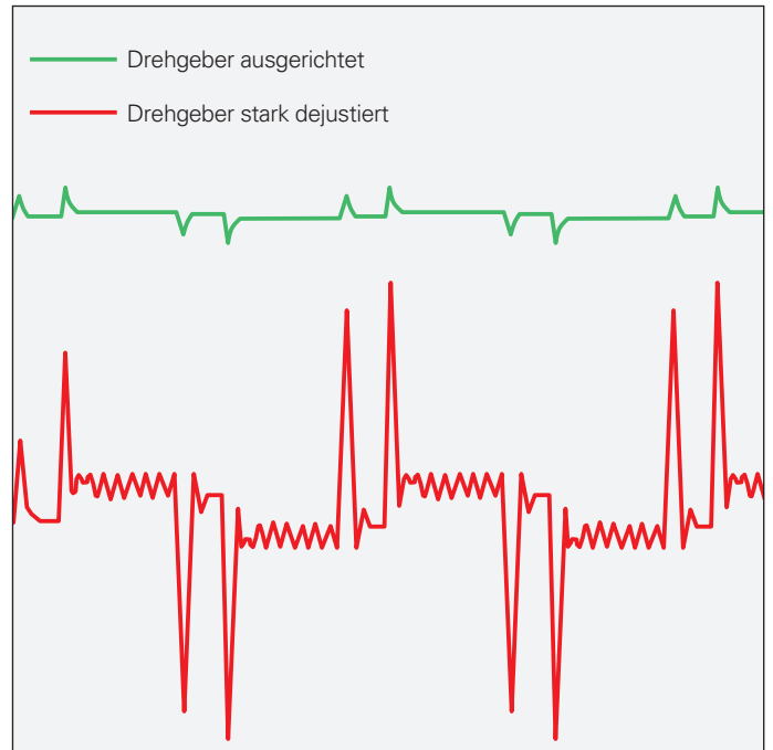
Motorstrom bei justiertem und stark dejustiertem Drehgeber
